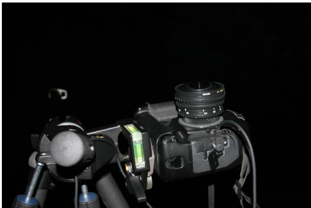
Slika 6: Digitalni fotoaparat Canon EOS 1Ds, velikost senzorja 4064x2704 pik, (25x36mm), opremljen z objektivom ribje oko Peleng 3.5/8 mm, ki naredi 180° projekcijo neba v krog s premerom 24 mm. Tako z enim samim posnetkom pokrijemo celotno vidno nebo.
