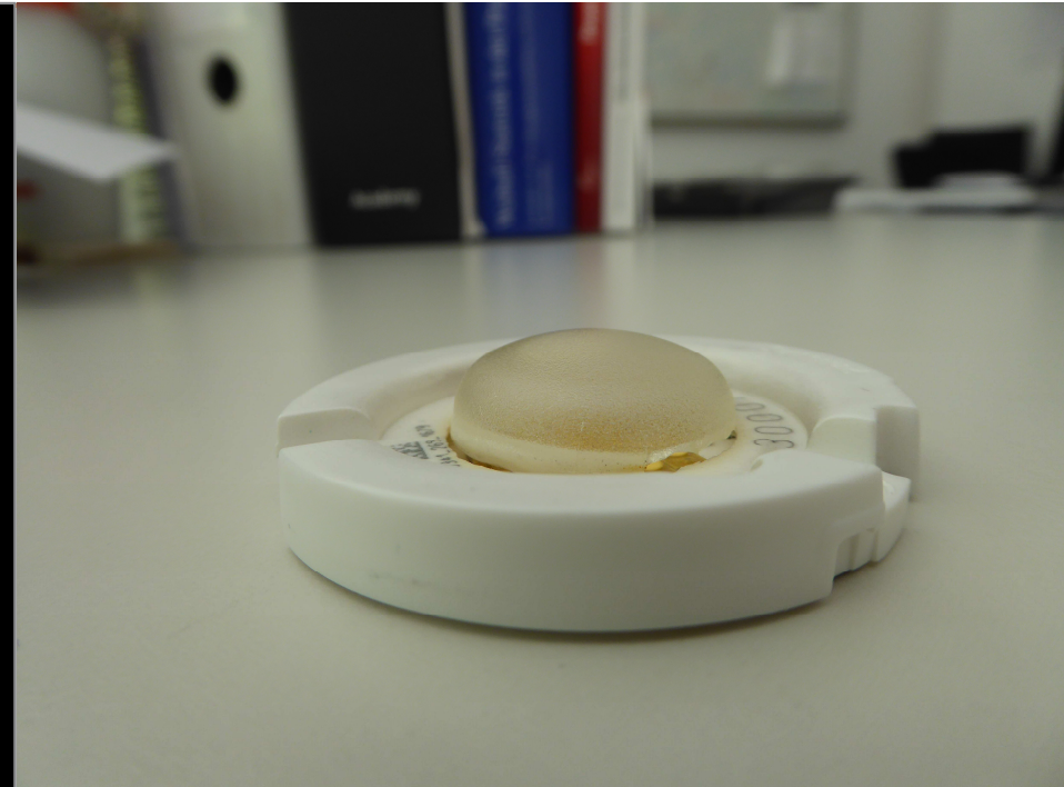
Foto: Polycarbonat Linse – Vergilbung nach Temperatur & Blaeintrag
